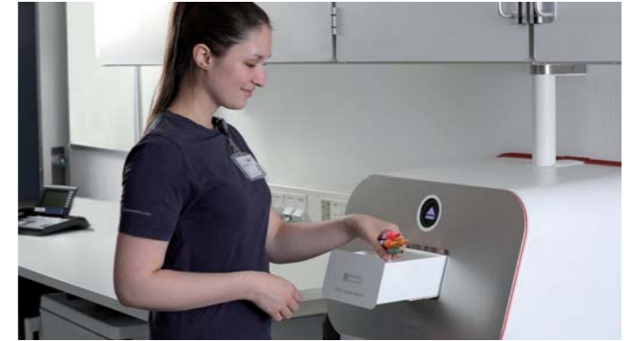
Aynı anda en fazla 25 numune için çoklu giriş.
