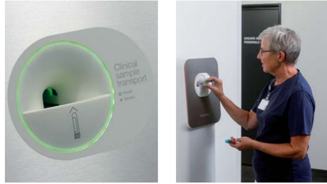
Numune tüpleri Vita istasyonunun giriş yuvasına yerleştirilir.
