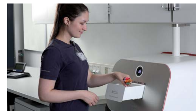
Wielokrotny wlot dla maksymalnie 25 próbek jednocześnie.
