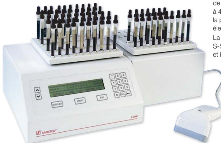
Fruit de la longue expérience de SARSTEDT dans le domaine de la VS, le dispositif automatisé de mesure de la VS sanguine à 40 canaux Sediplus® S 2000 se caractérise par le recours à la procédure de mesure de transmission IR et par son système électronique ultramoderne géré par microprocesseur.
