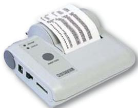
L'imprimante thermique est un dispositif léger et compact équipé d'un port RS 232 (SUB-D) servant à la sortie des données de mesure des dispositifs Sediplus® S 100, S 200 et S 2000. Équipée d'un boîtier ABS robuste, elle travaille sans usure. La batterie intégrée permet un fonctionnement indépendamment de l'alimentation réseau.
